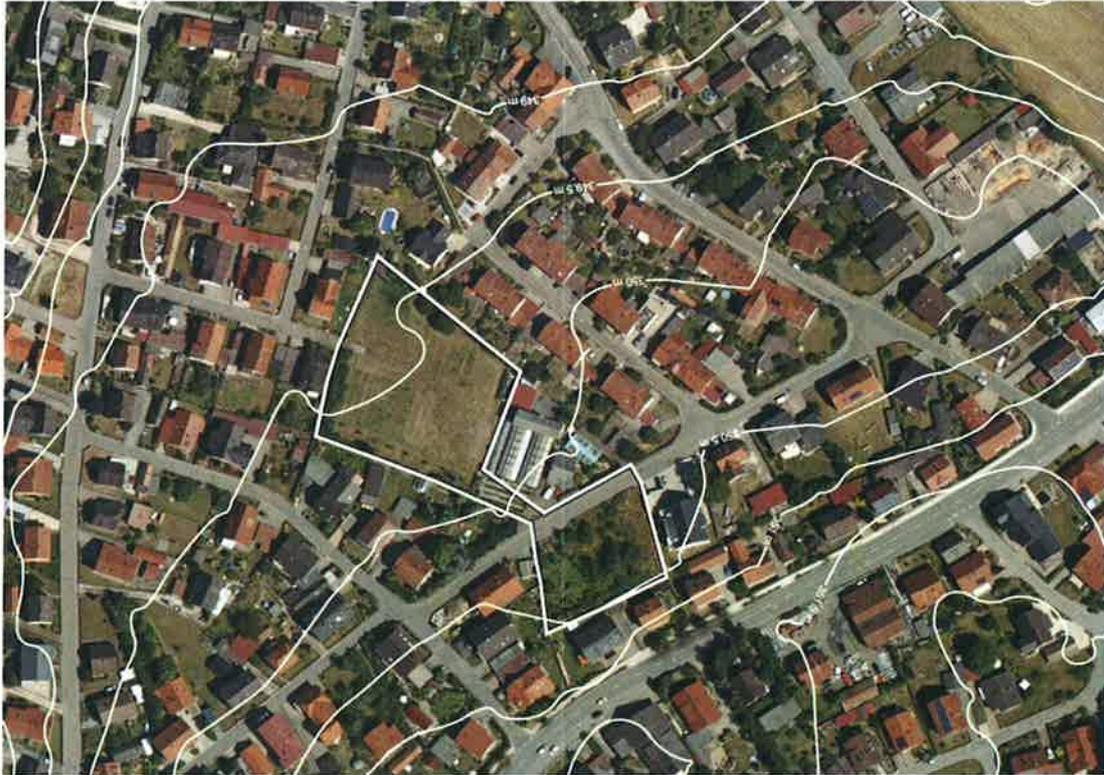
**Abbildung 1: Topographie im Geltungsbereich<sup>1</sup> - Der Höhenunterschied der Isolinien beträgt 0,5 m**
